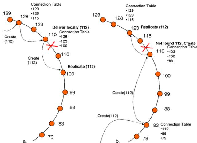
**Fig. 3** Inconsistent roots in DHT
